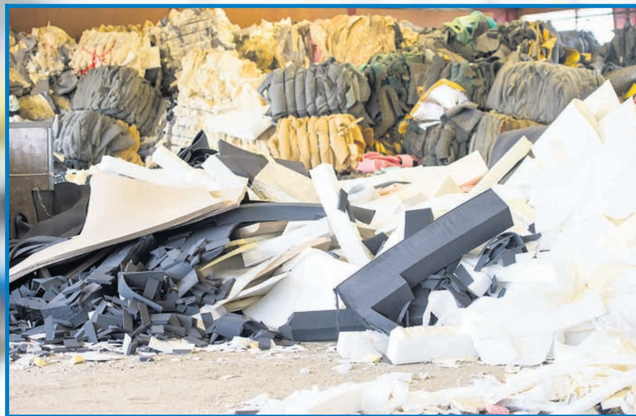
Intet skum går til spilde. Afskårne skumstykker bliver samlet og granuleret og samlet igen i nye plader, der bruges som lydæmpende materiale.
